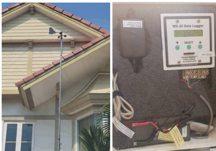
ภาพที่ 3.3 เครื่องมือวัดความเร็วลม (ซ้าย) วัดความเร็วลม 200-WS-25 (ขวา) เครื่องบันทึกข้อมูล 200-WS-02F
