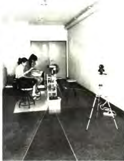
ภาพที่ 2 การติดตั้งอุปกรณ์ในห้องทดลอง หมายเลข (1) กล้องวิดีโอ (2) แก้วฮี (3) พัดลม (4) พัดลมไอเย็น (5) อุปกรณ์วัดความเร็วลม (6) อุปกรณ์วัดอุณหภูมิและความชื้น
